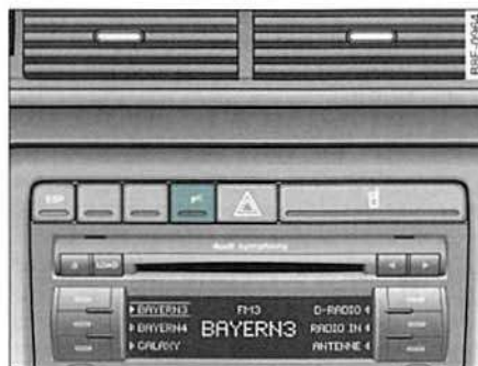
Fig. 141 Detalle de la consola central, interruptor para ayuda de aparcamiento
