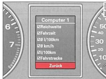
Fig. 32 Pantalla: Menú Computer 1 (Ordenador 1), se ha seleccionado la opción de menú Zurück (Retorno)
