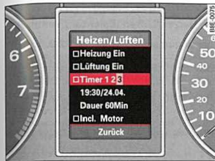
Fig. 127 Puesto de conducción: Pantalla del FIS, menú Heizen/Lüften (Calentar/ventilar), se ha seleccionado el Timer 3 (Reloj temporizador 3)
