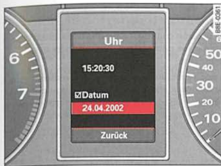
Fig. 36 Pantalla: Menú Uhr (Hora), se ajusta Datum (Fecha)
