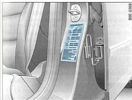
Fig. 221 Tabla con las presiones en el montante de la puerta
