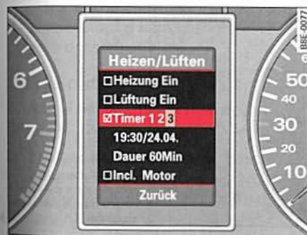
Fig. 130 Puesto de conducción: Pantalla del FIS, menú Heizen/Lüften (Calentar/ventilar), se ha seleccionado el Timer 3 (Reloj temporizador 3)
