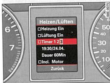
Fig. 128 Puesto de conducción: Pantalla del FIS, menú Heizen/Lüften (Calentar/ventilar), se ha seleccionado el Timer 3 (Reloj temporizador 3)
