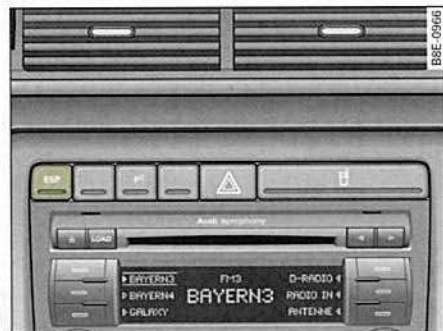
Fig. 192 Consola central con el interruptor del ESP
