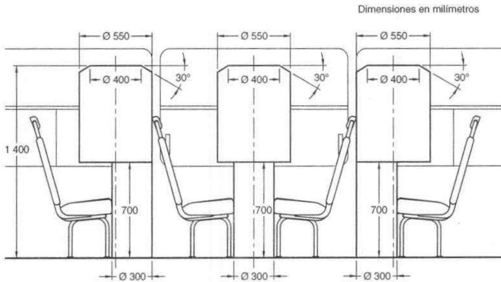
Figura 2. Desplazamiento de las galgas hacia la puerta de emergencia
